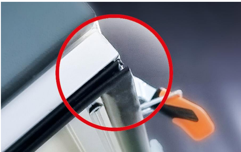
Abbildung 1: Aus dem Stempelabdruck einer Dichtung wurde ein EPDM-Profil gezeichnet und zeitnah ein erstes Muster gedruckt. Nach Freigabe des Musters wurden 500 Meter Dichtungen als erste Serienmenge gefertigt. Eine maßgefertigte Schneidvorrichtung ermöglicht das saubere Ablängen. Bildquelle: KREMER®.
