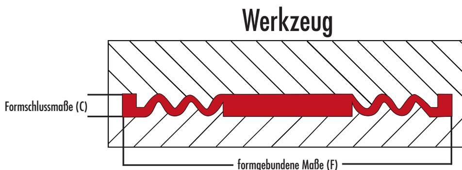
Formschlussmaße C sind abhängig von der Dicke des Austriebs in der Formtrennung und eines möglichen seitlichen Versatzes der Werkzeughälften.
