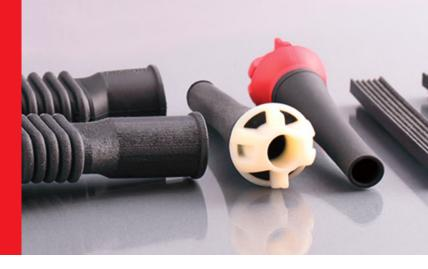
Mit dem 3D Prototypen-Druckverfahren können detailgetreue, auch mehrkomponentige Prototypen in einem Arbeitsschritt hergestellt werden. Dies geht bis zur Herstellung von Hart-Weichverbindungen in einem Arbeitsgang.
