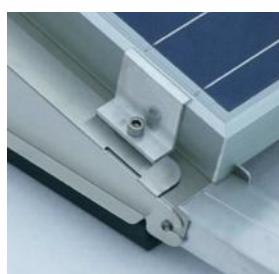
Der EPDM-Gummifuß wird bei Flachdach-Aufständerungssystemen von Photovoltaik- und Solaranlagen für alle leicht geneigten Flachdächer verwendet, um eine Beschädigung der Dachhaut während der Montage und dem späterem Einsatz zu verhindern.
